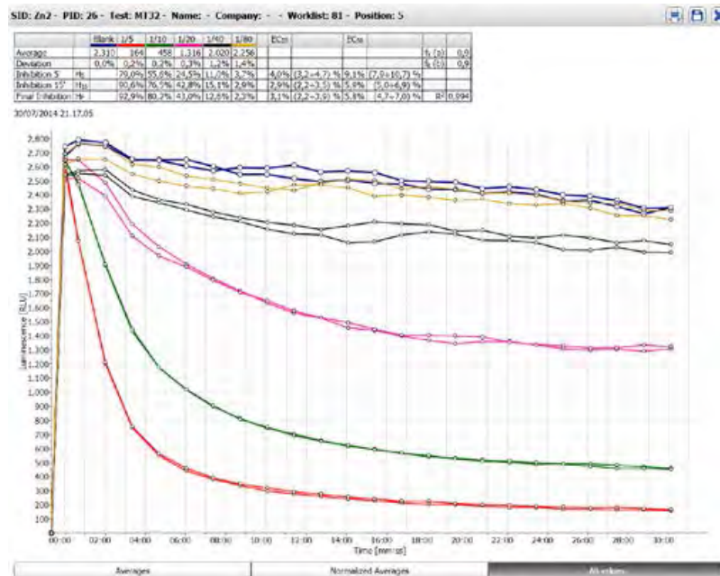
Figura 1 – EasyChem Tox; Rapporto di saggio di un test con ZnSO 4 *H 2 O ( V. fischeri , Modern Water)
