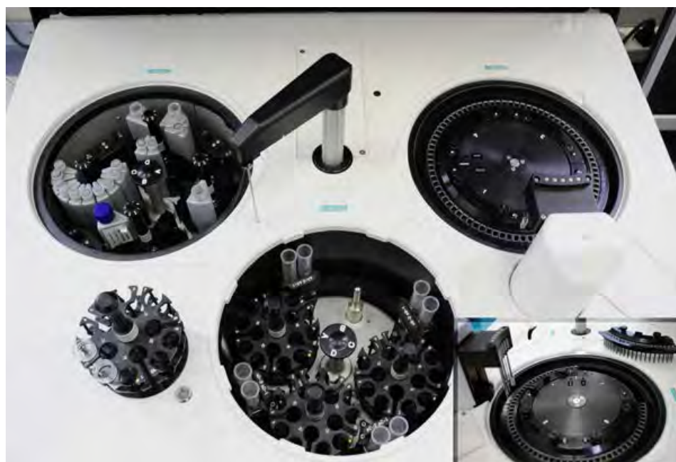
Figura 3 – L'analizzatore EasyChem Tox; sono visibili il comparto dei reagenti (a sx), dei campioni (al centro in basso), il braccio con l'ago per il trasferimento dei reagenti (al centro in alto) e il vano per la lettura dei campioni (a dx) con la torre di lavaggio delle cuvette. In basso a destra un particolare del comparto di lettura dei campioni
